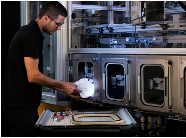
Faible effort de maintenance : remplacement des brosses en quelques secondes, temps d'arrêt réduit pour le remplacement des porte-verres
